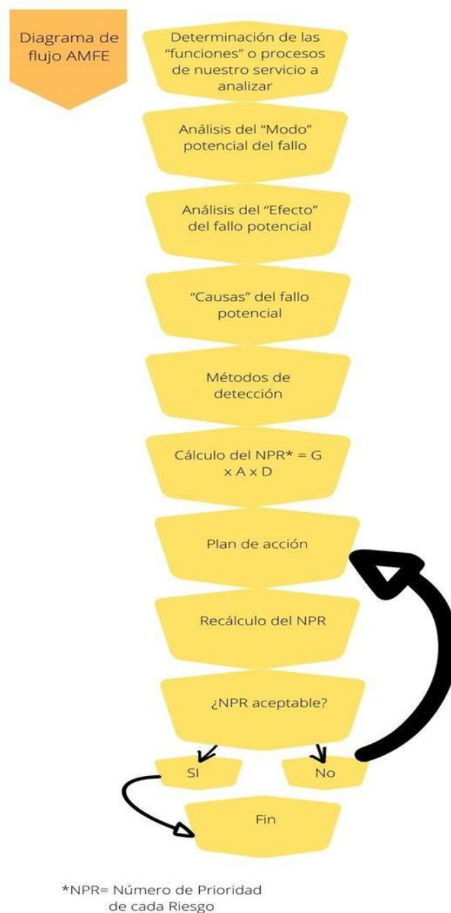
Figura 4. Diagrama de flujo AMFE. Organización Panamericana de la Salud & organización mundial de la salud. (2015). Métodos de análisis de eventos adversos.
