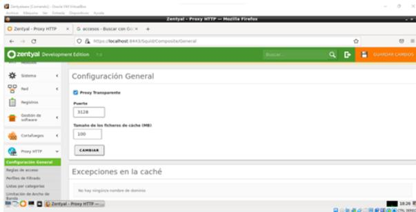
Fig. 80, se ingresa a la configuración general para activar el Proxy Transparente.
