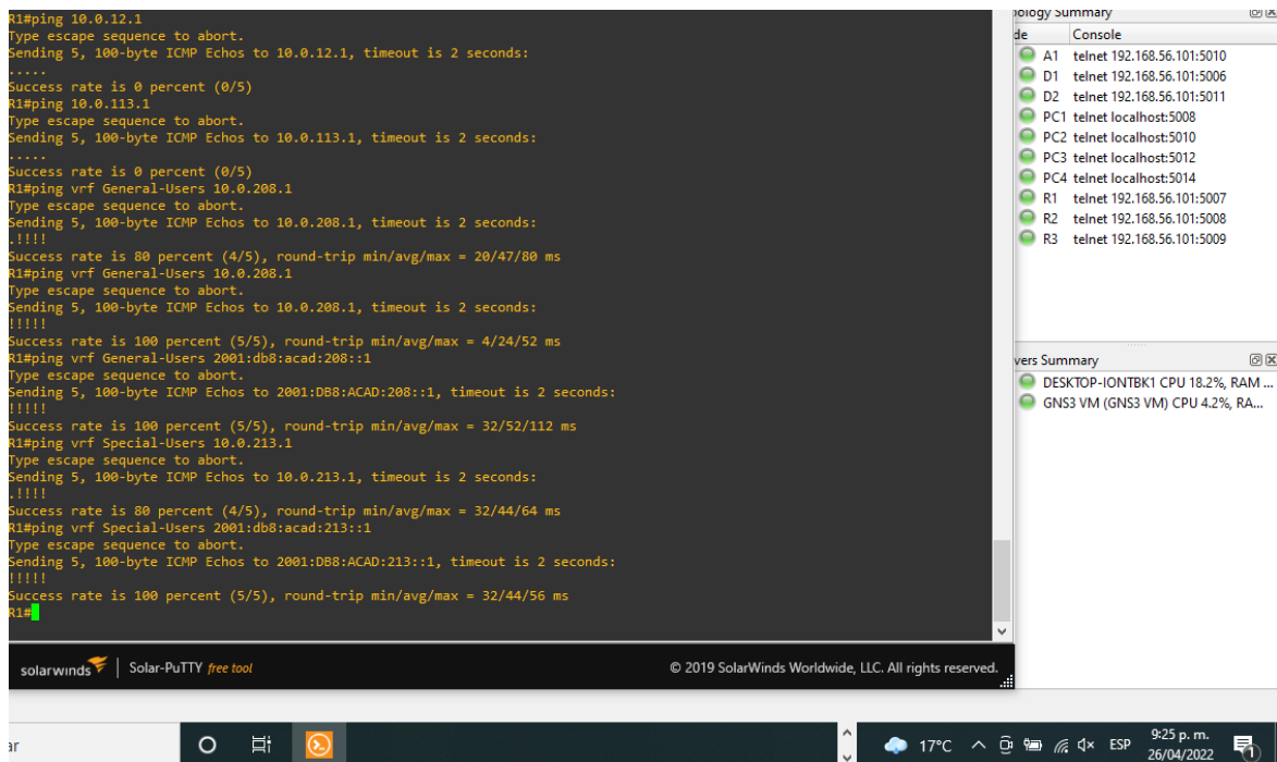
Figura 73. Realización de ping a las VRF - Fuente propia
