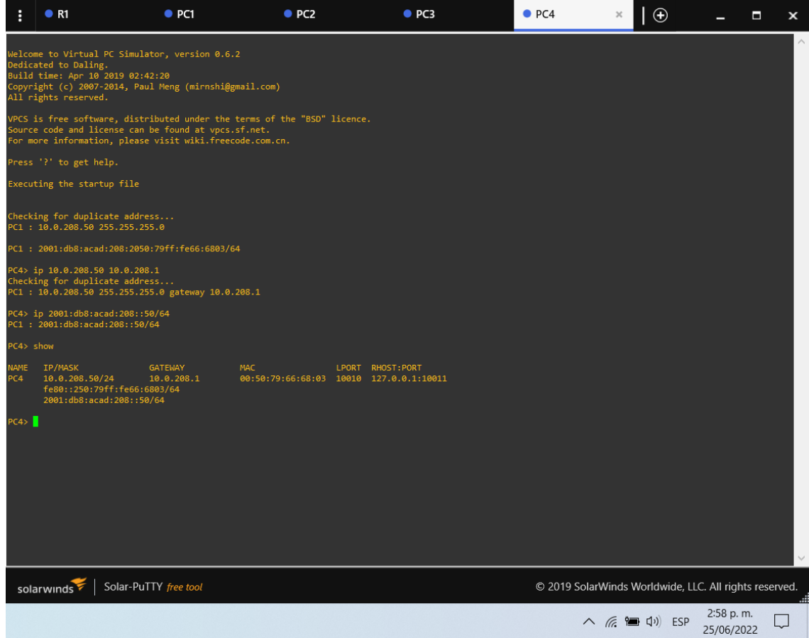
Figura 5. Verificación y conectividad en PC4.
