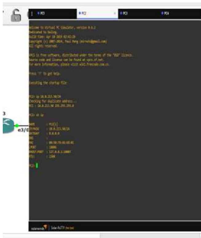
Figura 11. Configuración y visualización IP v4 PC 2 - Fuente Andrés Eduardo Hurtado
