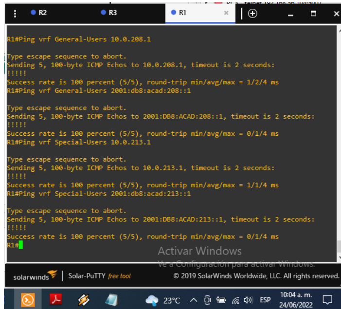
FIGURA 19. Verificación de conectividad a R3
