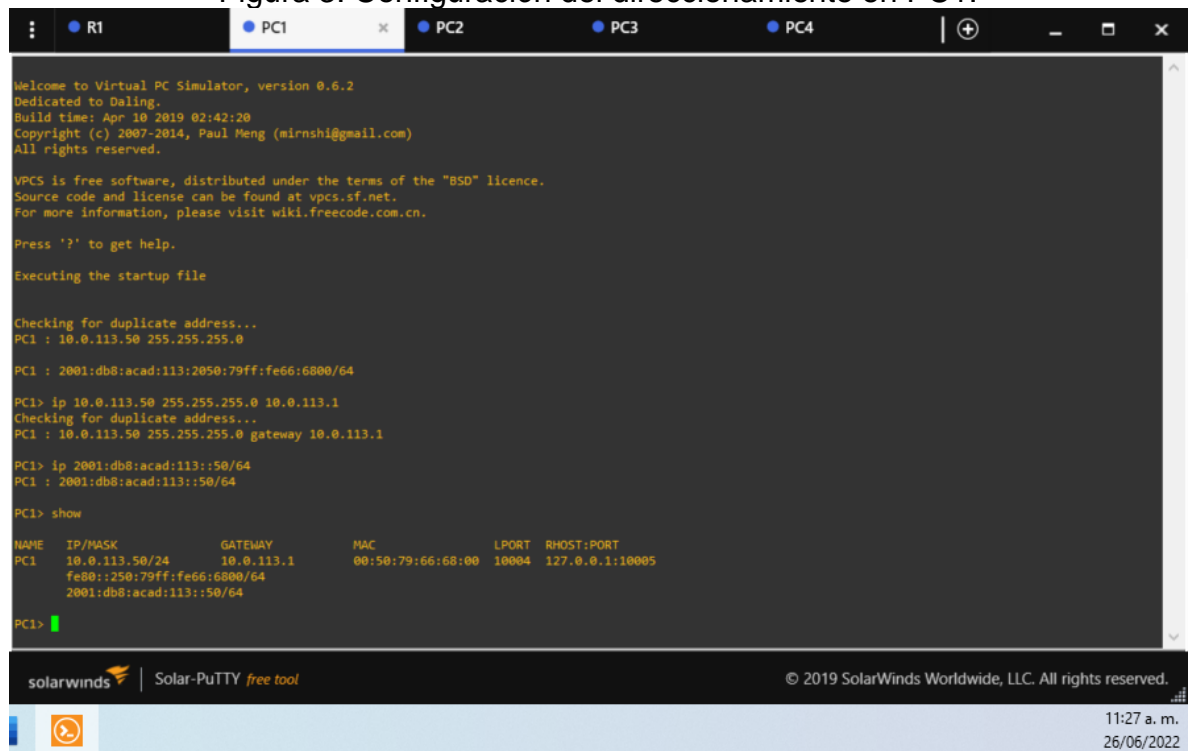
Figura 3. Configuración del direccionamiento en PC1.
