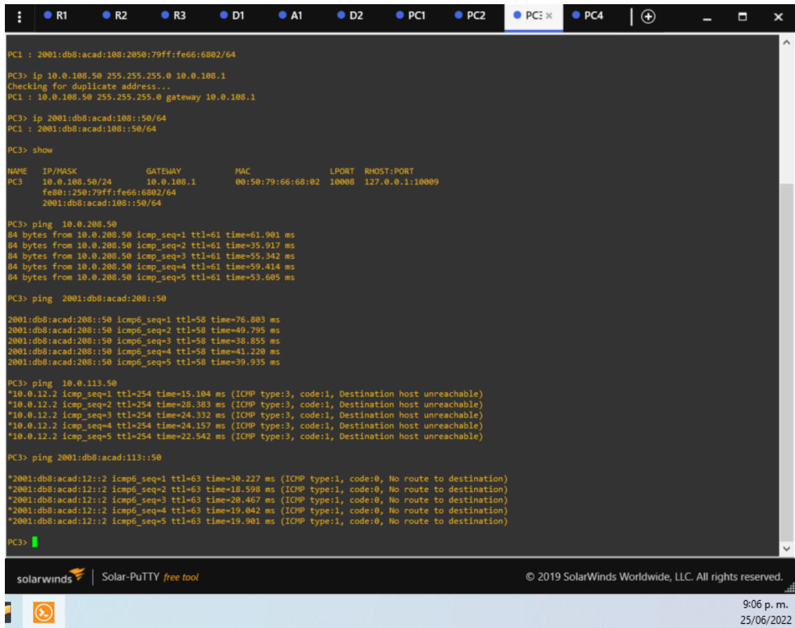
Figura 9. Prueba de conectividad entre PC3 y PC4, validación con PC1.
