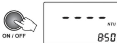
Nota: Al ponerlo en marcha, el instrumento muestra durante un segundo el rango en el LCD. El rango que tiene el instrumento al ponerse en marcha es el que ha sido utilizado en último lugar antes de desconectar el instrumento.
