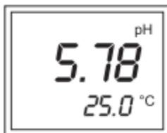
El valor pH con compensación automática de temperatura se muestra en la pantalla primaria mientras que la pantalla secundaria muestra la temperatura de la muestra.
