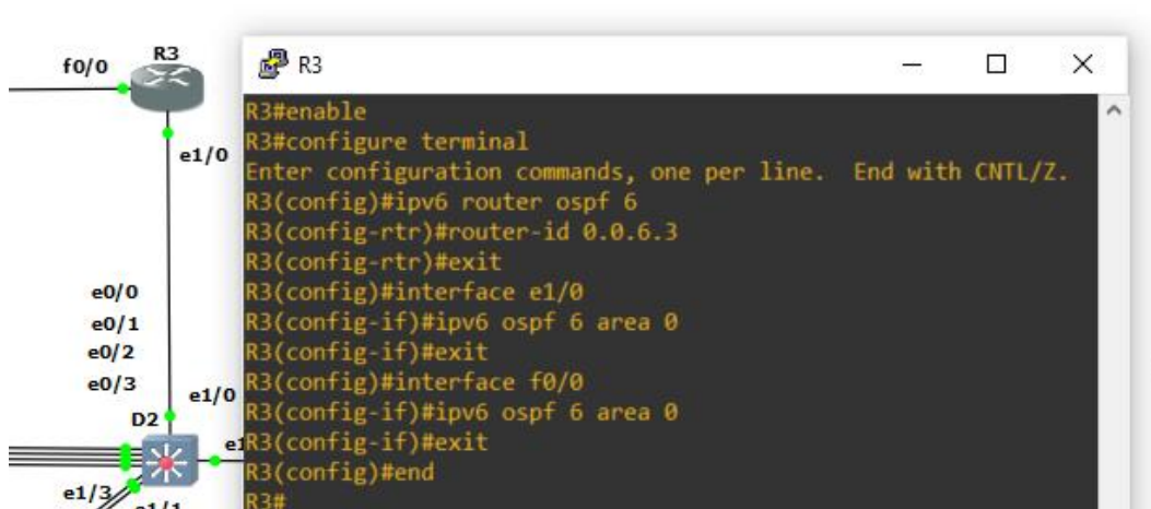
Figura 39. Configuración OSPFv3 en R3
