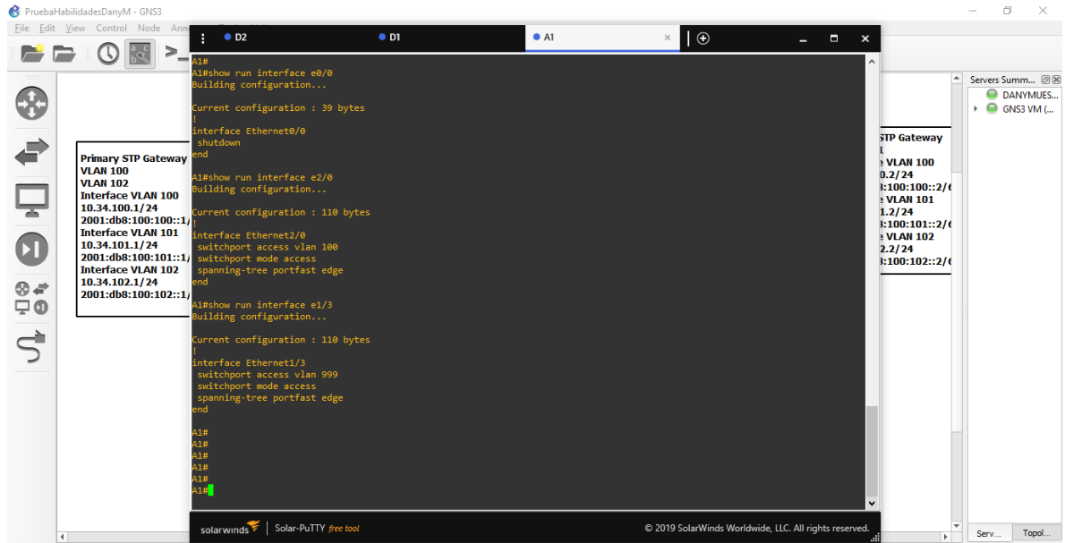
Figura 13. Configuración interfaces e0/0, e1/3, e2/0 en A1
