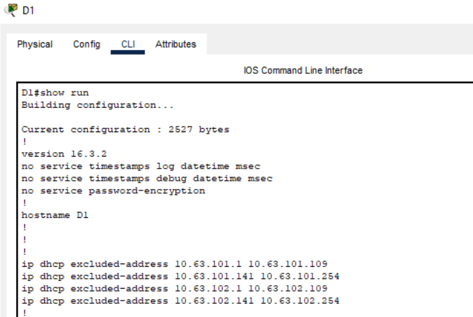
Figura 31. Configuración del standby switch D1
