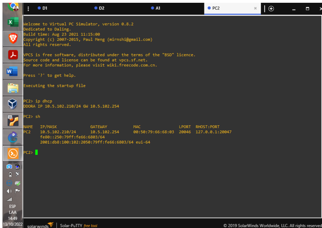
Figura 14. Comprobación de IPv4 DHCP.
