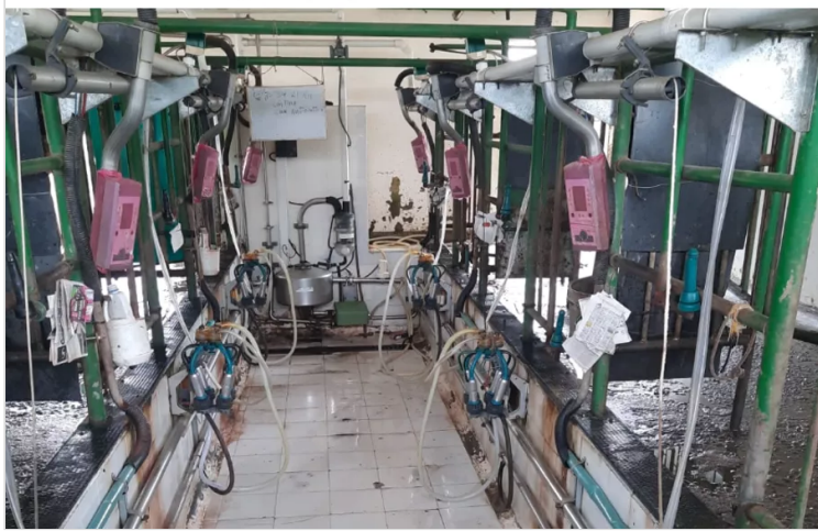
Figura 4: Beltrán, F. (2022). Sistema de Ordeño Automatizado Marengo el cual cuenta con 06 puestos de ordeño, [Fotografía].
