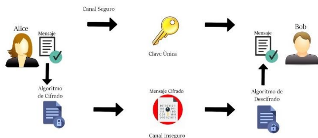
Figura 2 la clave única se intercambia entre Alice y Bob que se comunican antes de la transmisión de los datos por un canal seguro, mientras que el mensaje cifrado se envía por un canal inseguro. Para cifrar el mensaje el algoritmo de encriptación lleva a cabo una serie de sustituciones y transformaciones en el texto plano por su parte el algoritmo de descifrado en el cifrado de clave simétrica es el inverso del algoritmo de cifrado.
