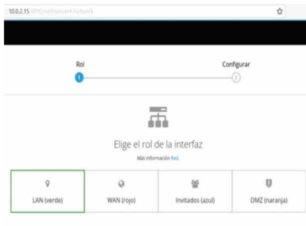
Figura 15. Configuramos la red LAN (verde).
