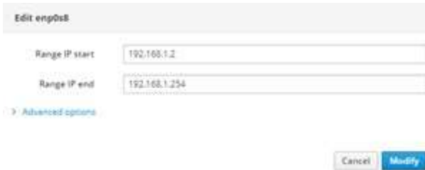
Ilustración 40 configuración rango DHCP imagen propia
