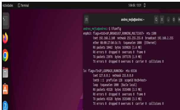
Figura 63: Asignación de IP a través de la red LAN (05 de diciembre de 2022) elaboración propia.
