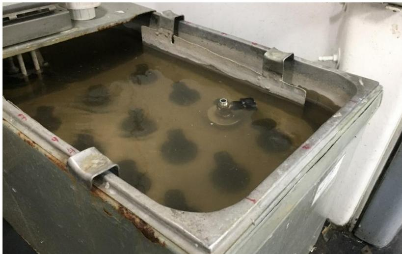
La bala con la muestra de reacción en su interior permaneció en el baño de calentamiento durante el tiempo establecido, posterior a este calentamiento se enfrió a temperatura ambiente y se retira la tapa con la llave para obtener el aceite desasfaltado y el asfalto que se incorporó a las paredes de la bala y al mezclador interno.
