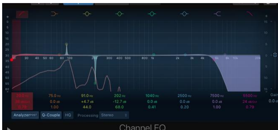
Figura 57. Ecualización bajo eléctrico
