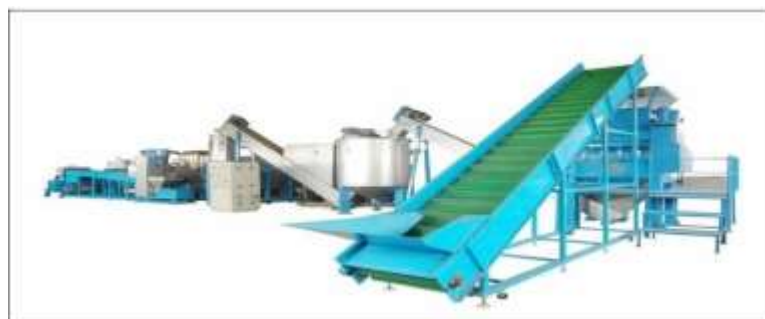
Ilustración 16: Máquina de lavado, molido y secado de botellas.
