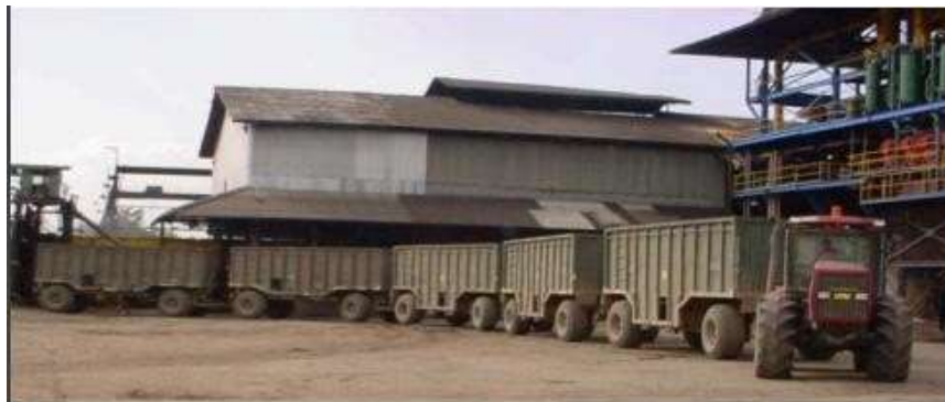
Figura 34. Tractor con vagones, transporte de la materia prima hacia área de preparación y molienda.
