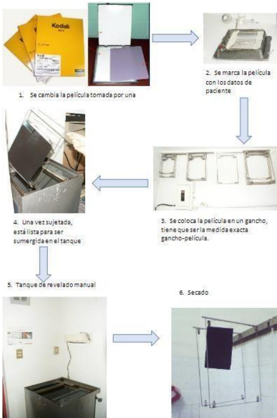
Figura 10. Esquema de procesado de la imagen manual con agentes químicos.
