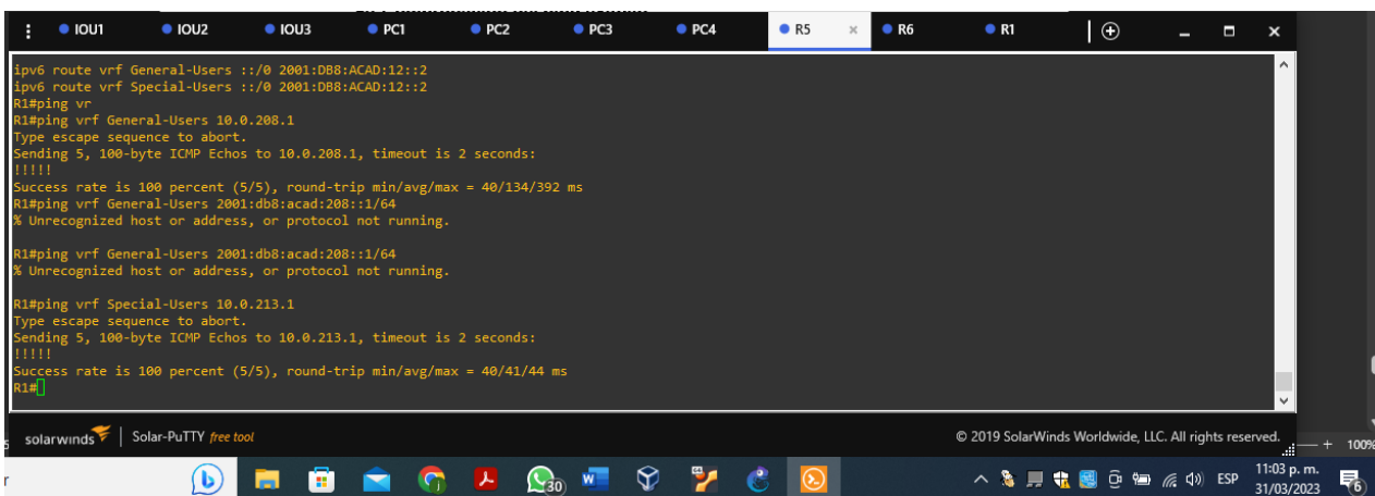
Ilustración 14 Uso del comando ping vrf Special-Users 10.0.213.1 en R1 para verificación de conectividad
