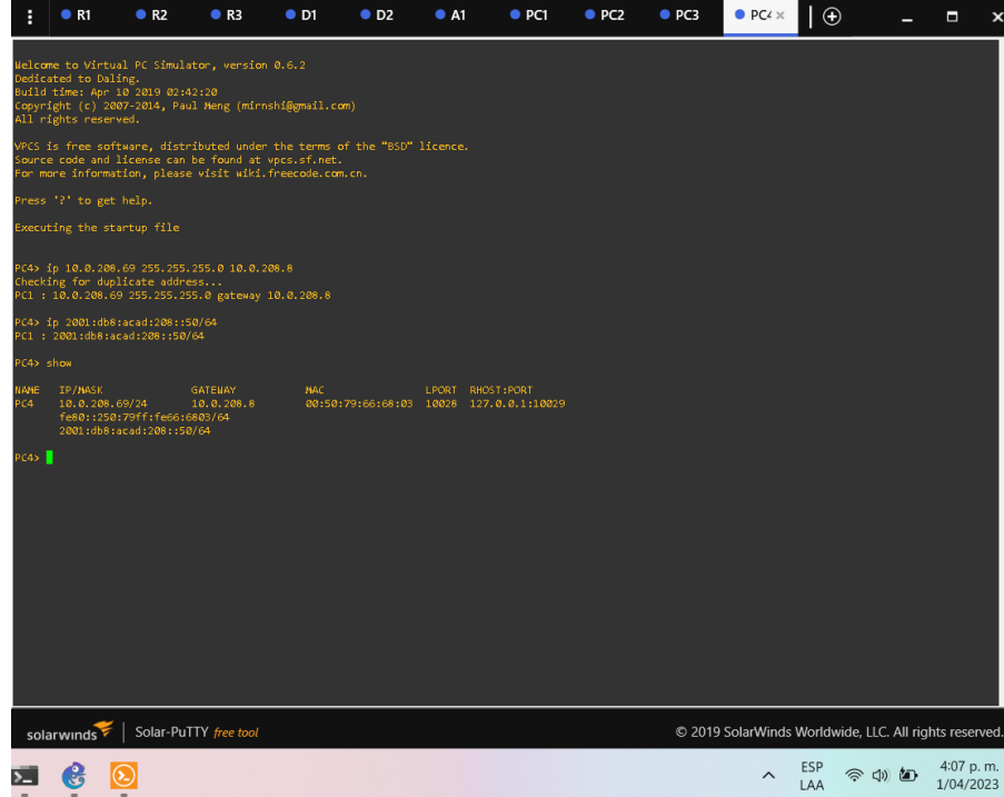
Figura 6. Verificación de la configuración de direccionamiento IPV4 en PC4.
