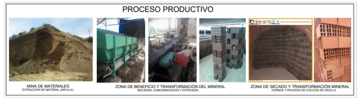
Figura 4. Proceso paso a paso ladrillera San Juan
