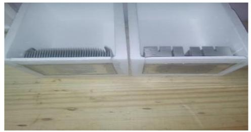
*Nota*. Prototipo construido para determinar el comportamiento de la celda Peltier con relación al efecto Seebeck.
