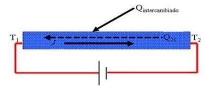
*Nota*. Imagen sobre el efecto que se genera sobre un material al ser aplicada una corriente para mostrar las temperaturas generadas. Grupo de investigación de Ingeniería Térmica (2021).
