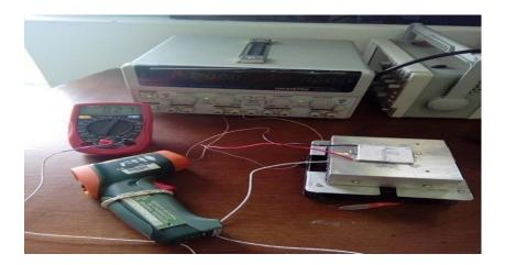
*Nota*. Prototipo incluido un disipador de temperatura para determinar el comportamiento de la celda Peltier ante la aplicación de voltaje.
