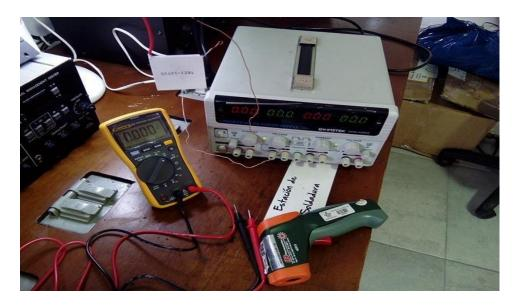
*Nota*. Celda Peltier e instrumentos utilizados para la medición de temperaturas, como reacción al aplicar un determinado voltaje.
