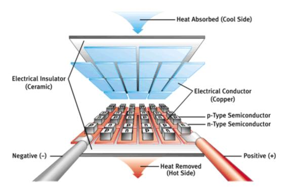
Nota. Esta figura expone la estructura física de una celda Peltier se observan los elementos semiconductores dispuestos electrónicamente en serie y térmicamente en paralelo. Profesional Review (s.f.).
