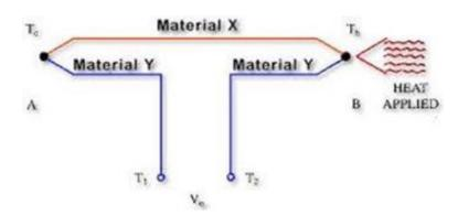
*Nota*. Fenómeno físico Seebeck presentado al aplicar una fuente de calor a dos materiales diferentes. Goldsmid (1964).
