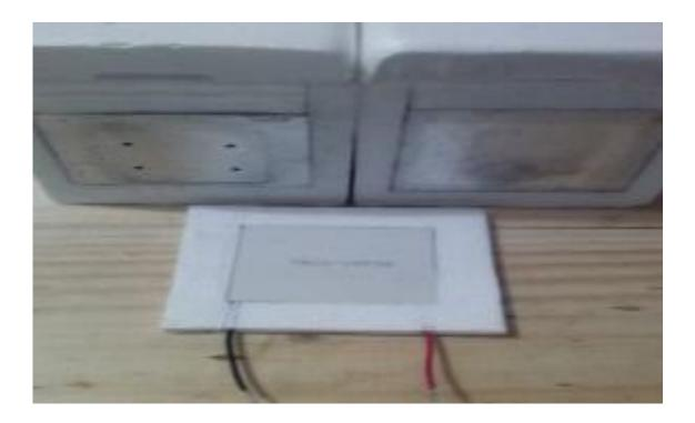
Nota. Celda Peltier utilizada en las pruebas realizadas.
