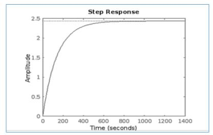
Nota. Respuesta de la función de transferencia indicando la estabilidad del sistema.
