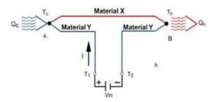
*Nota*. Imagen que muestra como al aplicársele voltaje a dos materiales diferentes estos reaccionan liberando temperaturas diferentes. Herranz (2008).
