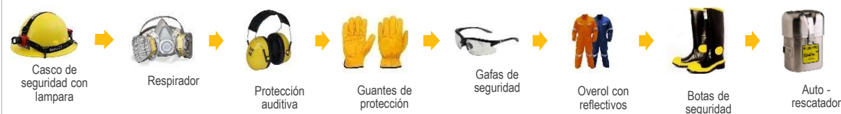
Figura 4. Elementos de Protección Personal mínimos para los trabajadores operativos que ingresan a las minas
