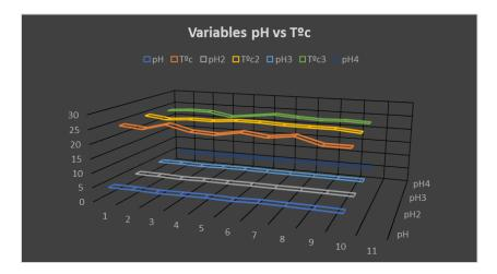
Revisando el comportamiento de las variables se puede concluir que al trascurrir de los días, la temperatura dentro de los reactores disminuye de manera considerabla en proporción directa al valor del pH en los recatores, el cual tiende a subir el indicador, lo que arroja un adecuado comportamiento del sistema iniciando su proceso.
