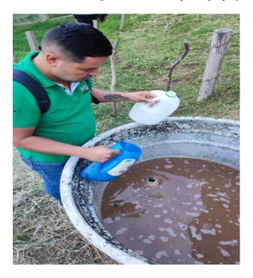
**Figura 21** *Embalaje de muestras de agua para laboratorio*
