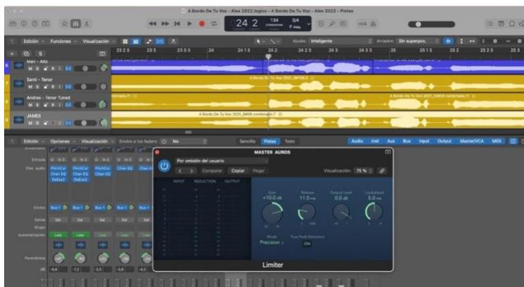
**Limitador.** El Limitador funciona de manera muy similar a un compresor, pero con una diferencia importante: mientras que un compresor reduce la señal proporcionalmente cuando esta sobrepasa el umbral, un limitador baja cualquier pico que lo supere al nivel del umbral, con lo que limita la señal a este nivel.
