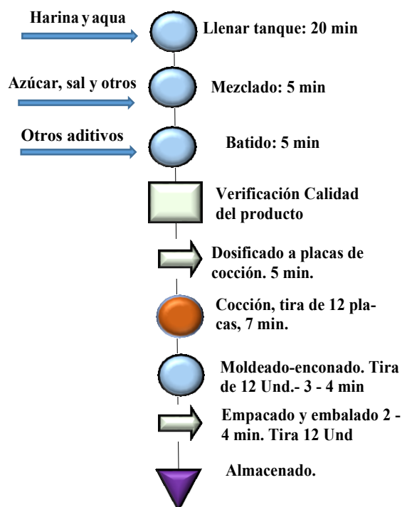
Figura N.12 Diagrama de proceso
