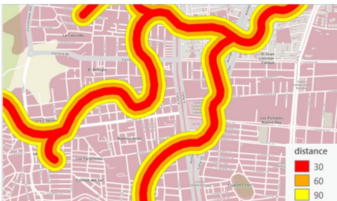
Figura 10. Zonas de riesgo por el paso de un drenaje simple
