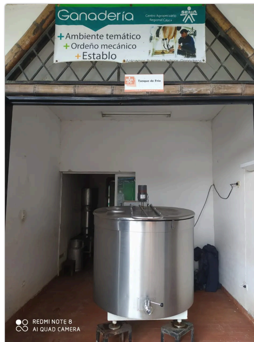
Figura 4. Tanque de Frío área de Ordeño, Ganadería
