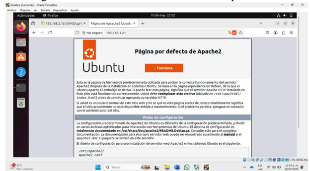
Figura 47. Verificación de conexión en el puerto 80.
