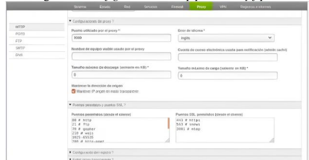
Figura 30. Configuración de http puerto 80 y ftp 21
