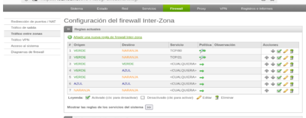
Figura 21. verifica visualmente la activación de reglas en el tráfico entre zonas
