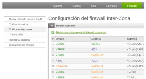
Figura 30 Seleccionar menú “Firewall” y submenú “Tráfico entre zonas”
