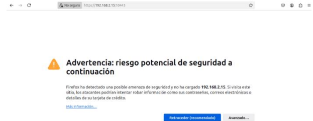
Figura 18: Se ingresa la ip 192.168.2.15:10443 para poder acceder al endian, es importante tener presente que debemos de acceder en la opcion de avanzado para continuar el proceso de instalacion
