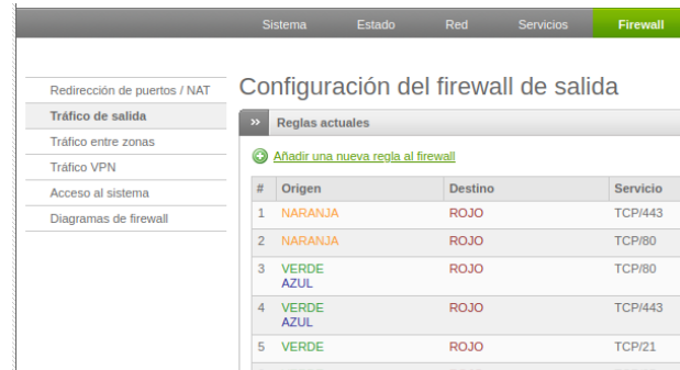
Figura 35. Acceder al menú firewall y al submenú Tráfico de salida
