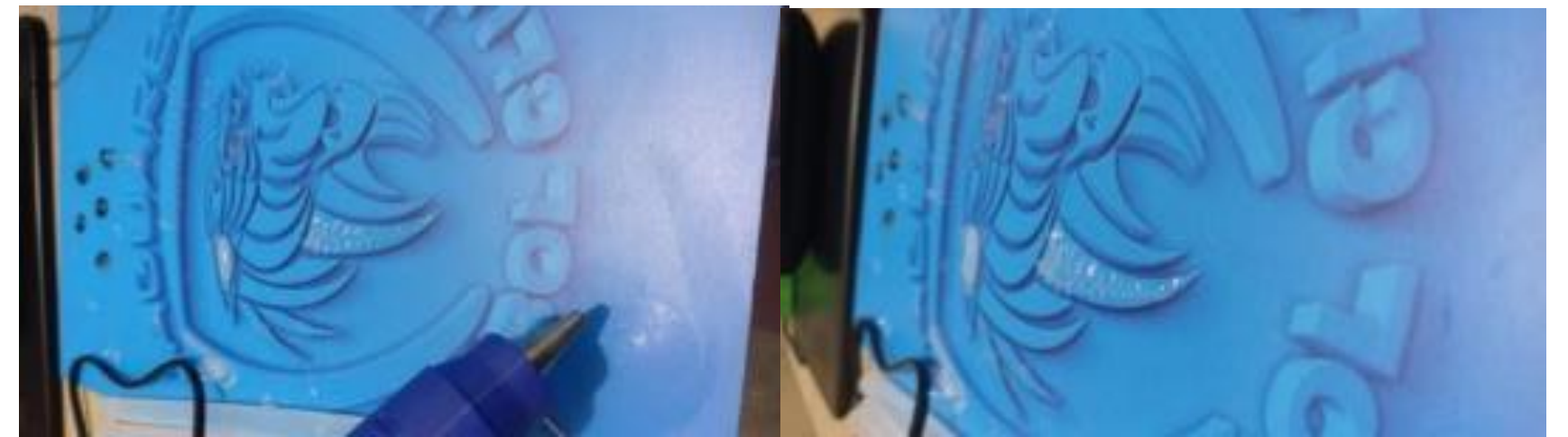
Figura 37: Prueba de material para texturas Silicona líquida sobre vinilo laminado brillante sobre MDF
