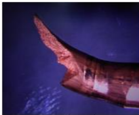
Rotura boca de pez
