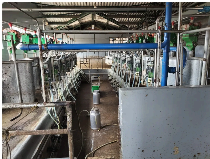
Figura 2. Sala de ordeño en espina de pescado con 16 puestos y unidades de ordeño
