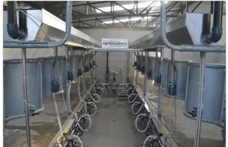
Figura 2.Sala de ordeño espina de pescado 16 puestos
