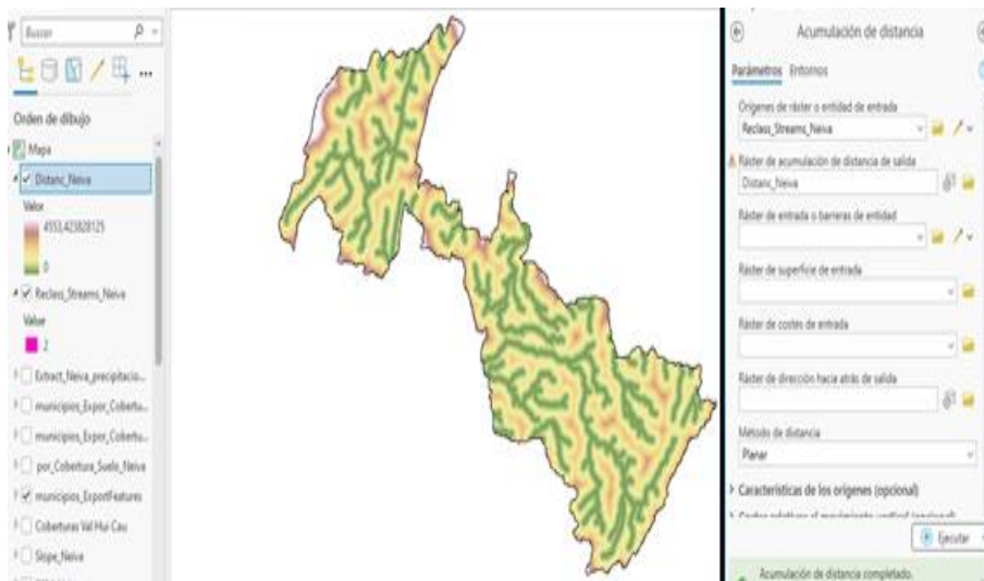
Figura 7. Distancia entre drenajes
