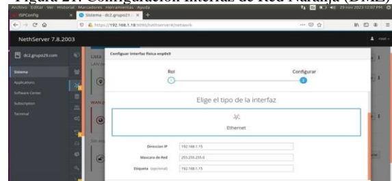
Figura 21. Configuración Interfaz de Red Naranja (DMZ)
