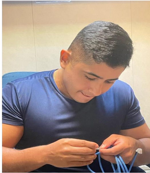
Figura 8: Ponchado cable de red conector RJ45.
