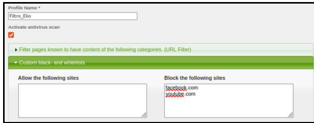
Fig. 35. Configuración de perfiles de filtrado y gestión de listas negras para la restricción de dominios.
