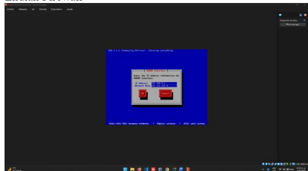
Figura 2. Configuración de la interfaz de la zona Verde (LAN) en Endian Firewall
