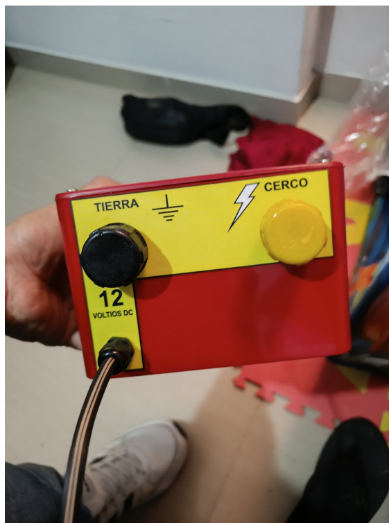
(b) Envoltente sellado con prensaestopas
