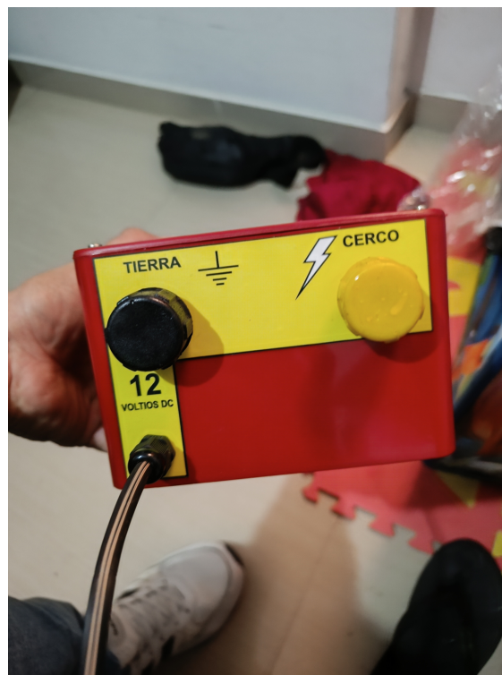
(b) Envoltente sellado con prensaestopas
