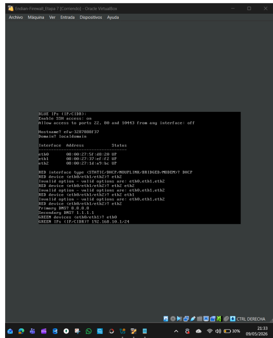
Fig. 8 Configuración de interfaces de red en Endian Firewall para usar NAT
