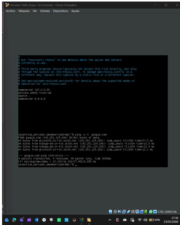
Fig. 17. Validación de conectividad, desde el servidor Ubuntu Server dentro de la DMZ, hacia Internet, empleando ICMP y DNS.
