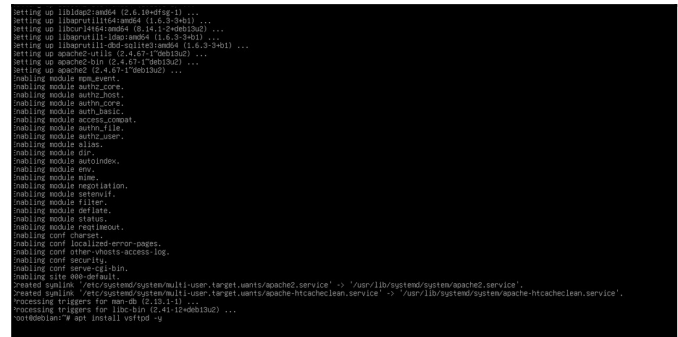
Figura 21. Instalación del servidor web Apache2 en Debian Server
